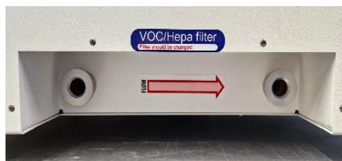
Figure 12.1 La flèche de flux sur les incubateurs de FIV MIRI® TL6 et MIRI® TL12 multiroom
