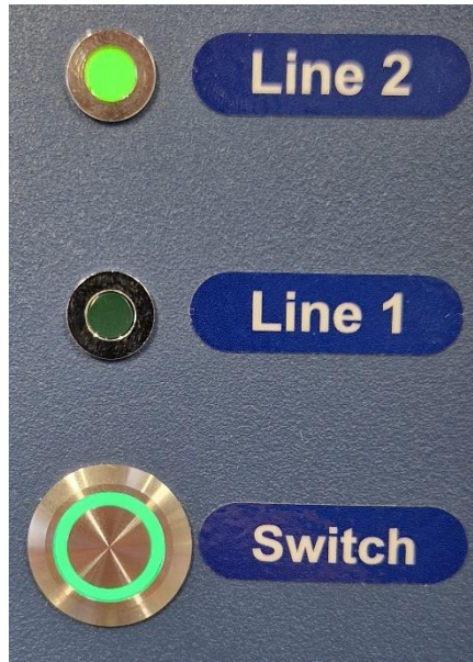
Figure 20.4 Le commutateur de changement de ligne de l'incubateur FIV multiroom MIRI® TL12 et la ligne 1 active
