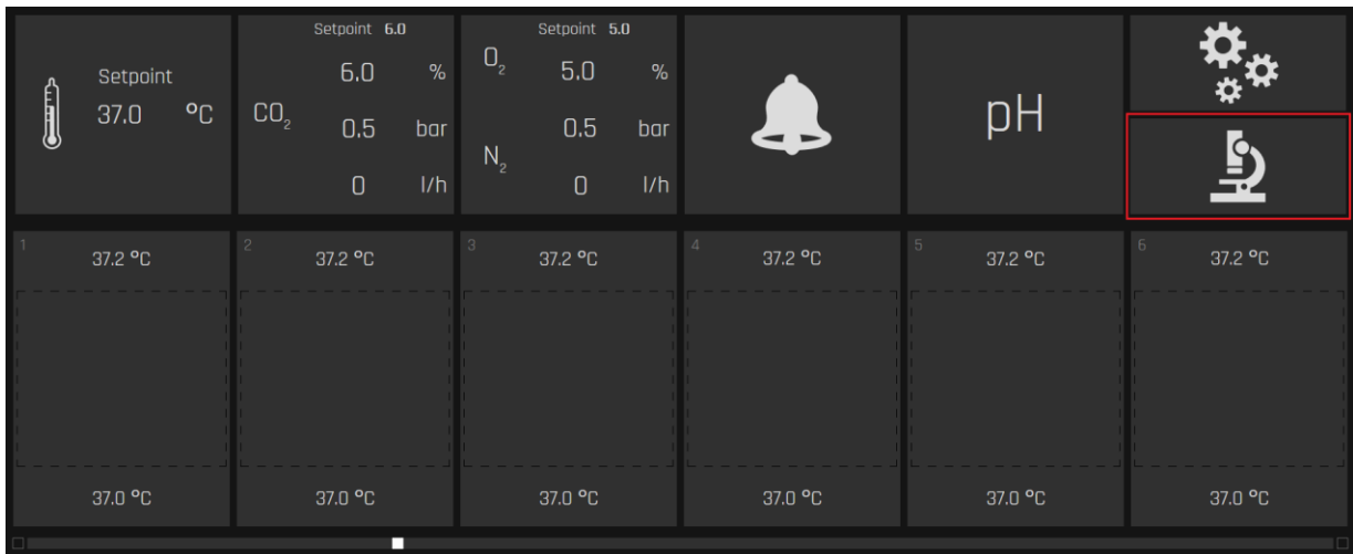
Figure 20.30 Bouton de mode LiveView sur l'écran principal de l'incubateur pour FIV à compartiments MIRI® TL6 ou MIRI® TL12
