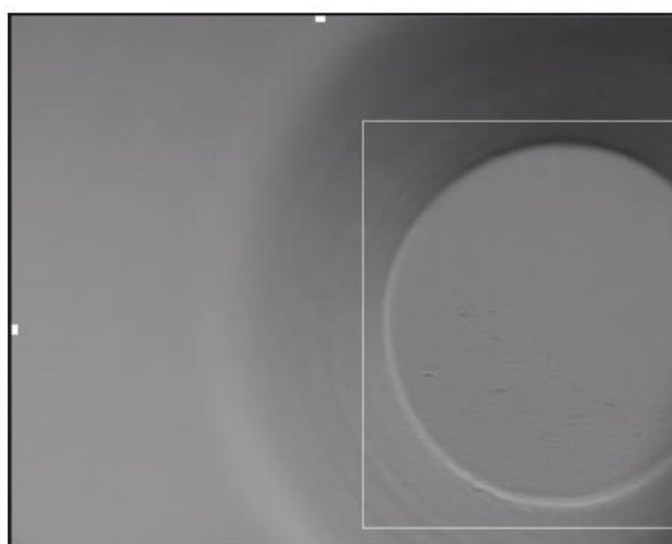
Figure 20.34 Exemple de position incorrecte d'un puits dans l'écran de visualisation de la caméra
