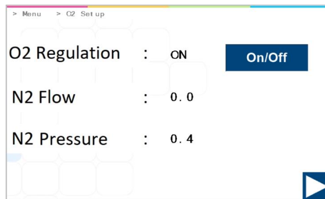
Figure 13.26 Affichage du sous-menu de configuration du O 2 de l'incubateur pour FIV multiroom MIRI® TL6 et MIRI® TL12
