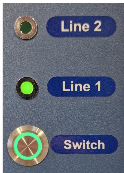
Figure 20.2 Le commutateur de changement de ligne de l'incubateur FIV multiroom MIRI® TL12 et la ligne 1 active
