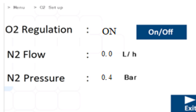
Figure 16.4 Affichage du sous-menu de configuration du O 2 de l'incubateur pour FIV multiroom MIRI® TL6 et MIRI® TL12
